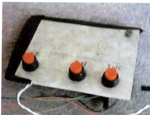
Fig. 5.5: montagem dos botões na bancada.
