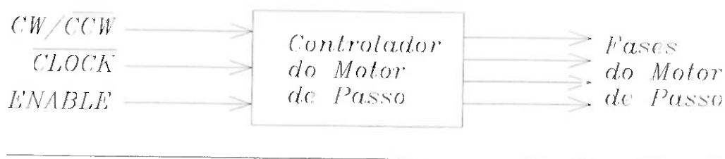
Fig. 5.18: entradas e saídas do controlador.
